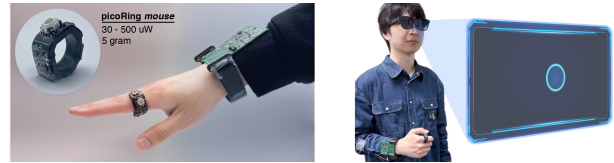
図2 picoRing mouse の概要。30-500 \mu W 級の超低電力で動作する超小型のリング型マウスであり、指先での入力に最適である。[17] より転載 (CC BY 4.0 ライセンスに基づく)。
